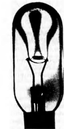
Рис. 7.41. Интерференционные полосы, наблюдаемые при восстановлении голограммы, полученной методом двойной экспозиции
